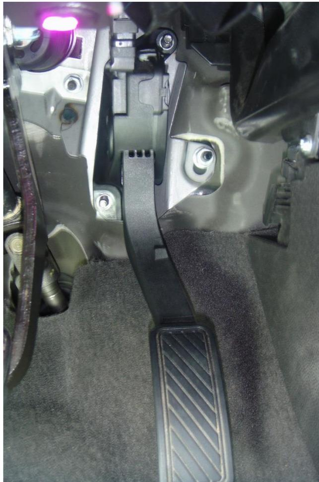
Este componente cuenta internamente con dos sensores tipo potenciómetro, los cuales cambian de voltaje de acuerdo a la posición del pedal , en este circuito cada uno de los potenciómetros es alimentado individualmente con tensión de referencia , y el circuito cuenta con 6 pines de conexión , los cuales se dividen en:
