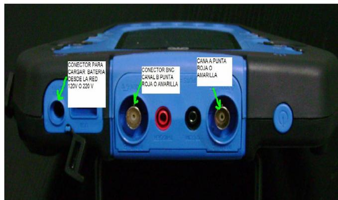
El cable que va ubicado en cada uno de los canales debe tener una punta tipo aguja que se ubica en el componente a medir, y un cable negro tipo cocodrilo que se utiliza para la referencia negativa, en la imagen inferior se puede apreciar cómo se debe conectar un osciloscopio en un proceso de medición cualquiera.
