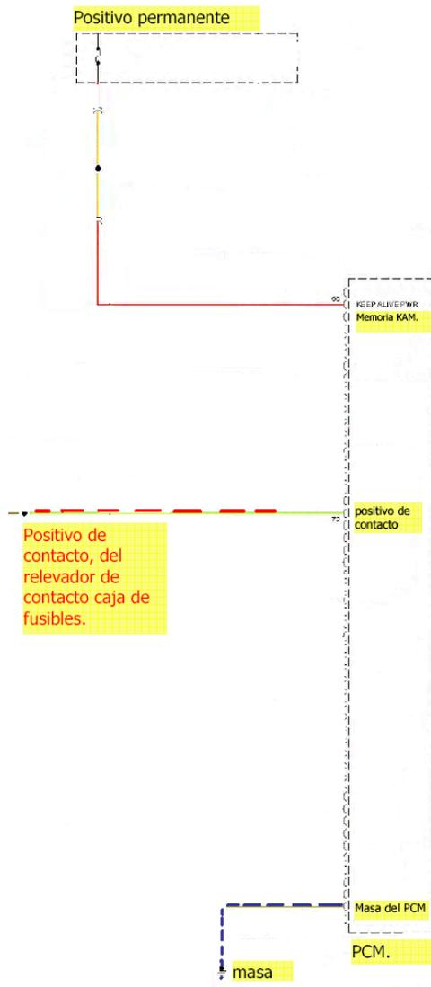
En esta disposición, el positivo en esta línea activa el relevador y entre 30 87 coloca positivo a la línea que va desde el relé de contacto hasta el relevador de poder del PCM, este positivo sombreado con rojo, permite que se active el relevador de poder, ahora al activarse este relevador, cierra los contactos y coloca positivo directo de batería al PCM, en el esquema este positivo, se puede ver con el nombre de línea positiva a PCM.
