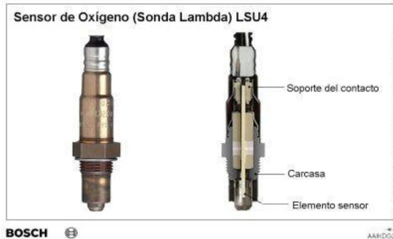
El sensor va a trabajar en un rango aproximado a 3 voltios en el cable del sensor, al interior del PCM el efecto de la mezcla genera un cambio en el sentido de la corriente la siguiente tabla muestra un ejemplo del cambio en el sentido de la corriente aunque el voltaje permanezca muy constante.
